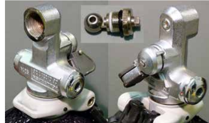
Das Scubapro Modulo mit Kugelventil und 1/4-Drehung für auf oder zu. Obwohl einfach und verschleissfrei zu bedienen, konnte es sich nicht durchsetzen, zumal das angeschlossene Equipment unter dem plötzlichen Druckanstieg beim Aufdrehen litt. (Quelle: tauchen.stinn.eu )
