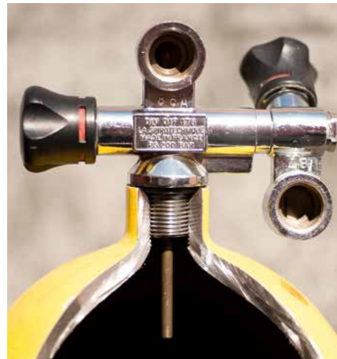
Aufgeschnittene alte Faber-Flasche mit modularem Ventil von La Spirotechnique, welche kurz darauf zu einem Blumentopf umfunktioniert wurde.
