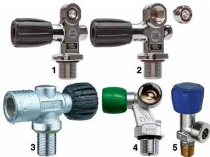
Beispiele für verschiedene Bauformen und Standards von Monoventilen. (1) Thermo Deluxe K mit Yoke/INT Anschluss (2) Thermo Pro mit 3/8" DIN 230 bar Anschluss und Yoke/INT Insert (3) Nautec SH mit 3/8" DIN 300 bar Anschluss (4) Aqualung Z-Ventil mit M26x2 (5) GCE 3/4" Sauerstoff-Ventil, kleinkonisch
