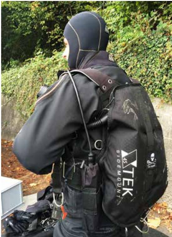
Das Scubapro Xtek ist ein reines Sidemount-Jacket. Als Gewichtssystem können hier Edelstahl-Backplates mit unterschiedlichen Dicken und P-Weight verwendet werden. Der Inflator-Schlauch wird bei reinen Sidemount-Systemen meist unter der Schulter über der Brust getragen.
