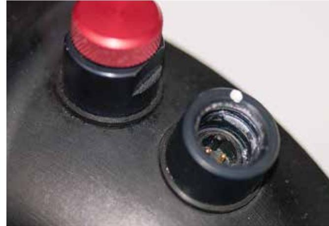
*Blitzbuchsen für elektrische Kabel gibt es fünfpolig (hier Modell Nikon N5) und sechspolig (S6). Für Blitze ohne TTL reichen drei Kontakte. Einen zweiten Blitz besser mit Y-Kabel ansteuern, nicht wie hier abgebildet, mit einer zweiten Buchse, da jede Bohrung eine weitere Schwachstelle bietet.*
