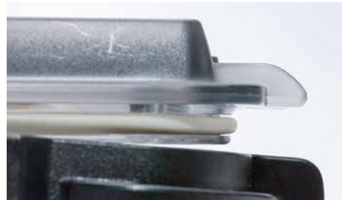
*Bei Gehäusen, deren Rückwand mit einem Scharnier verbunden ist, ist das Verschliessen besonders heikel. Der Druck auf den O-Ring ist ungleichmässig und er kann sich leicht verziehen, wenn er nicht genügend gefettet wird.*
