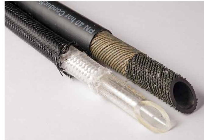
*Innerer Aufbau zweier Mitteldruckschläuche zum Vergleich. Flex-Schläuche bestehen aus einem inneren Schlauch aus Thermoplast, welcher mit zwei Geflechschichten umwickelt ist. Die innere ist sehr feinfaserig, dicht gewoben und dadurch druckbeständig. Die äussere ist locker und dient zum Schutz. Gummi-Schläuche bestehen aus zwei Lagen zusammen vulkanisierten Gummis, welche dazwischen zur Verstärkung zweifach grob umwickelt wurde.*
